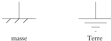
Figure 20.9 Symbole des masse et Terre.
