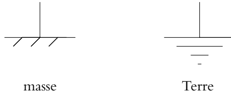
Figure 1.4 Symboles de la masse et de la Terre.
